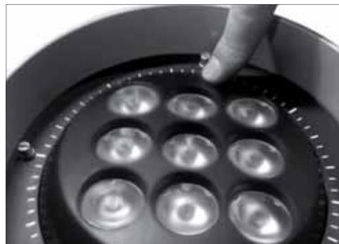
Fixer le VOLVENDO en serrant les vis / VOLVENDO durch Festdrehen der Schrauben fixieren
